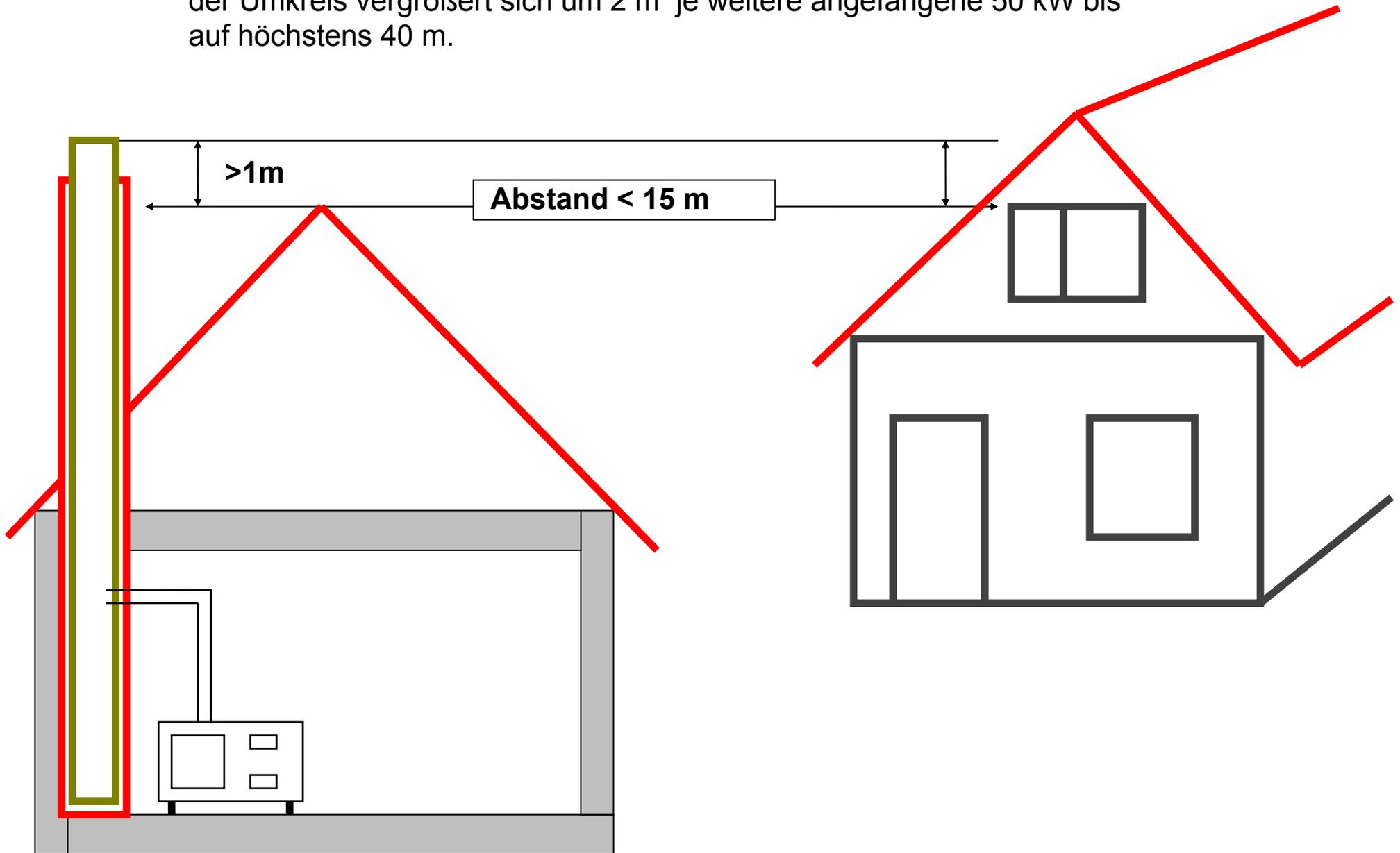
**§ 9 (1)** Die Oberkanten von Lüftungsöffnungen, Fenstern oder Türen um mindestens 1m überragen in einem Umkreis von **8m** bei **Feuerstätten für flüssige oder gasförmige Brennstoffe** mit einer Gesamtnennwärmeleistung bis 50 kW; der Umkreis vergrößert sich um 1 m je weitere angefangene 50 kW bis auf höchstens 40 m.
