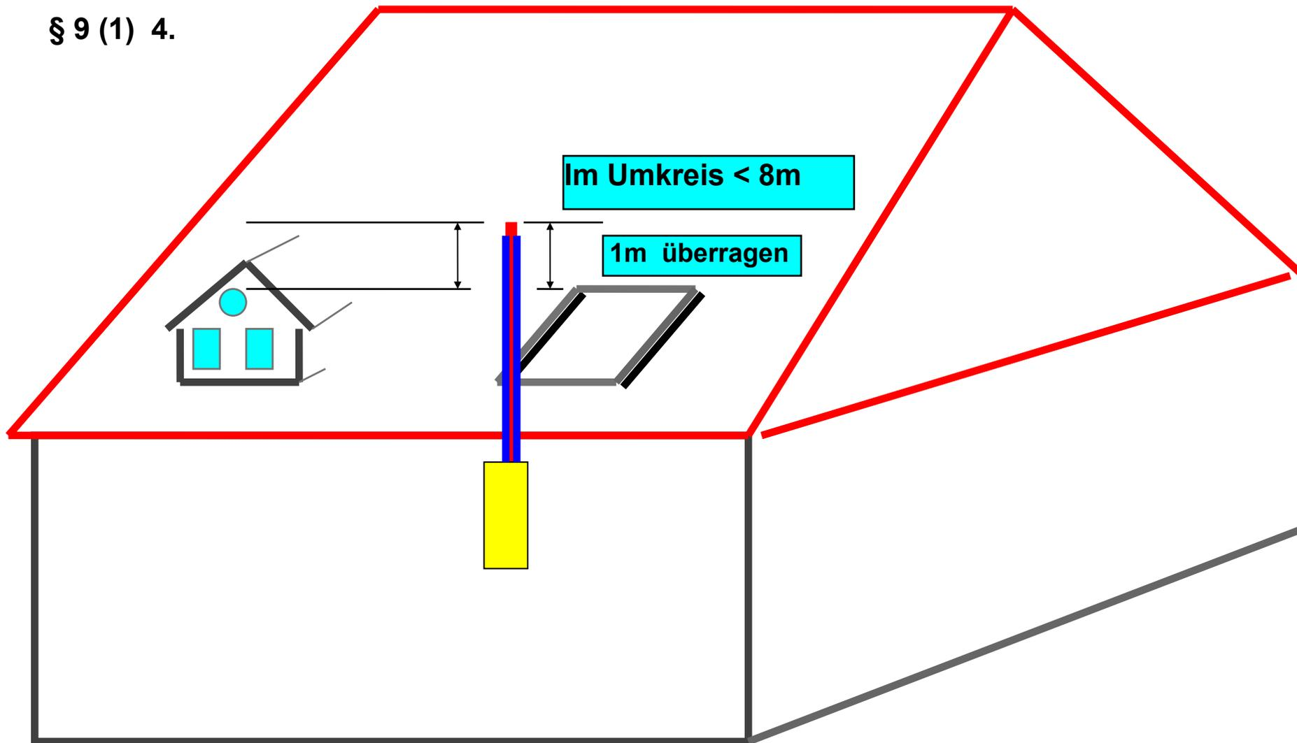
§ 9 (1) Die Oberkanten von Lüftungsöffnungen, Fenstern oder Türen um mindestens 1m überragen in einem Umkreis von **15 m** bei **Feuerstätten für feste Brennstoffe** mit einer Gesamtnennwärmeleistung bis 50 kW; der Umkreis vergrößert sich um 2 m je weitere angefangene 50 kW bis auf höchstens 40 m.
